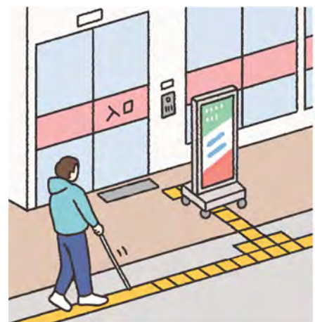
（例）運営開始後に、視覚障害者誘導用ブロック等に看板が置かれてしまい、適切に誘導ができない
