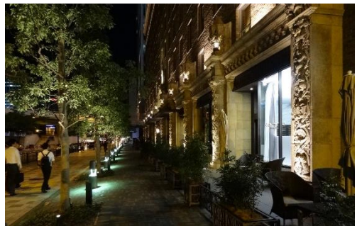
壁面や柱面などの鉛直面を照らすと、同じ照度で床面を照らす場合より、人の目には明るく感じられます。
