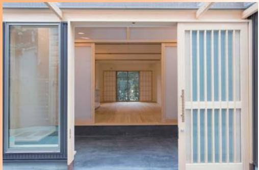
関西地区には、古い木造長屋をより現代の生活スタイルにあわせて改造・改築している物件がある。その多くは基本構造を変えずに外壁や間取りの変更、耐震補強を中心になっている。生野区にあるこの「翼NAGAYA」は、新築でありながらあえて木造長屋建築にしている。新築であることから既存の基本構造にとらわれず、自由な設計が可能となっている。T字型の敷地に建つこの長屋は、建物までのアプローチと玄関前の路地はフラットな空間として、建物外観はシンプルなデザインである。玄関は檜の引き戸で吹き抜けの広い土間は開放的な空間になっている。リビングの床にも檜の無垢材を使用するなど、至る所に木の温もりを感じさせると共に、使い勝手の良い対面型キッチンや通風に拘るなど、居住者目線に立った良質で丁寧なデザインは秀逸である。長屋の長所である近隣とのコミュニティを生かしつつ、プライベート空間を充実させるために、様々なところで設計者の意図を感じることができ、新築長屋の好例として評価したい。
