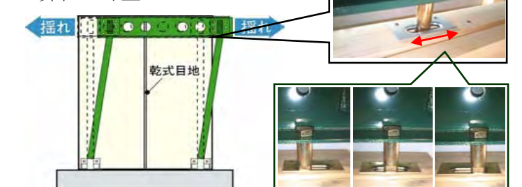
カーテンウォール構法の採用で外壁の損傷なし
