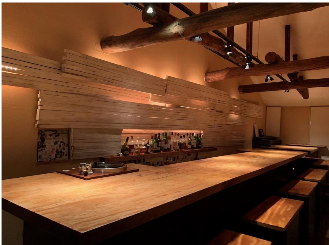
2022年にこの世を去った大阪のインテリアデザイナー、野井成正が手がけたバー。線と面の構成、素材と光のニュアンスを大切にした野井は、ここでは細長い空間を活かしつつ、束ねた長い杉の角材をあえて水に浸け、乾燥で捻れる隙間から間接光が漏れるボトル棚を背面にデザインした。木材のテクスチャーを石膏で塗りつぶす遊び心が野井らしい。図面もほどほどに、現場で自らも手を動かしながらつくりあげていく独特の空間は、多くの人々に愛されてきた。法善寺横丁の路地空間にある「川名」は、2002年の火災で延焼を受けたものの、野井の空間を修復して今も営業を続けている。(高岡伸一)
