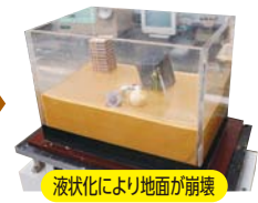
液状化により地面が崩壊
